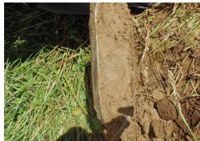
Autre carottage saturé d'eau dès 80 cm (sol sableux)
